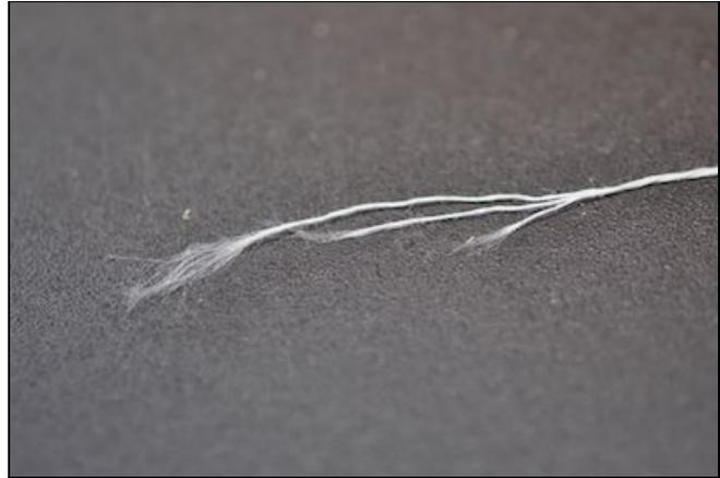
Fig. 1: untwisted 3-ply linen thread
